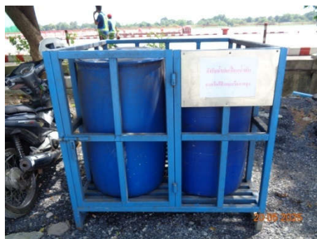
ภาพที่ 2.2-33 ถังรวบรวมน้ำมันจากเรือโป๊ะ และเรือลากจูง
